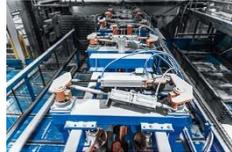
Didascalia: Trasporto, bloccaggio, centraggio: i cilindri a norma DNC e ADN resistono a polvere e trucioli. (Foto: Festo AG & Co. KG)
