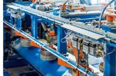
Didascalia: Si dimostrano estremamente robusti anche nella polvere della segheria: i morsetti funzionali flessibili CPX / VTSA con diversi moduli Fieldbus da PROFINET a Ethernet / IP e da Modbus a DeviceNet. (Foto: Festo AG & Co. KG)
